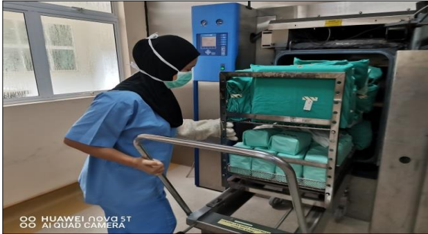
Gambar 11: Mengeluarkan set/ peralatan/ pek linen/ soft good yang telah melalui proses pensterilan dari Steam Autoclave
