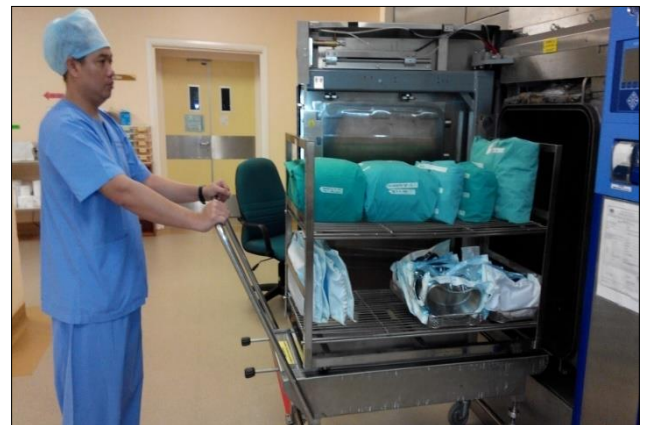
Gambar 8: Memasukkan set/ peralatan/ pek linen/ soft good untuk pensterilan menggunakan kaedah haba (Steam Autoclave)
